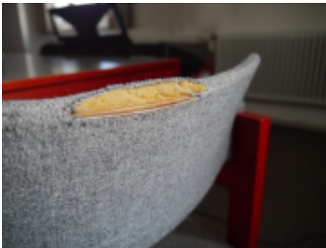
Bei manchen Stühlen platzt bereits der Stoff auf.
